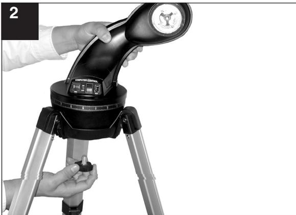
2. **Attacher l'assemblage du bras de montage:** Fixez l'assemblage du bras de montage sur la base du trépied. Enfilez la molette de blocage en l'introduisant par le dessous du sommet du trépied dans l'assemblage du bras de montage. Serrez fermement, sans plus. Ne serrez pas trop. Durant une observation, vous pouvez avoir besoin de desserrer cette molette pour faire tourner la monture avec le tube optique sur l'axe horizontal (voir étape 6 ci-dessous).
