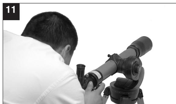
11. **Vision le long du tube:** Pour viser un objet, visiez le long du tube dans sa direction. Pratiquez l'utilisation des touches en flèche de l'Autostar afin de centrer un objet
