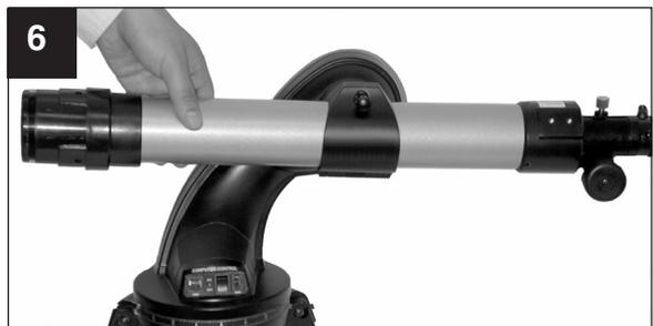
6. **Attacher et équilibrer le tube optique:** Remplacez le tube optique dans le collier. Serrez la molette de serrage du collier juste assez pour qu'elle tienne le tube lâchement; ne serrez pas la molette de serrage du collier pour l'instant. Faites le glisser en avant ou en arrière jusqu'à trouver la position où il restera horizontal (sans s'abaisser ni d'un côté, ni de l'autre). Serrez la molette de blocage du collier jusqu'à ce qu'elle soit ferme aux doigts.
